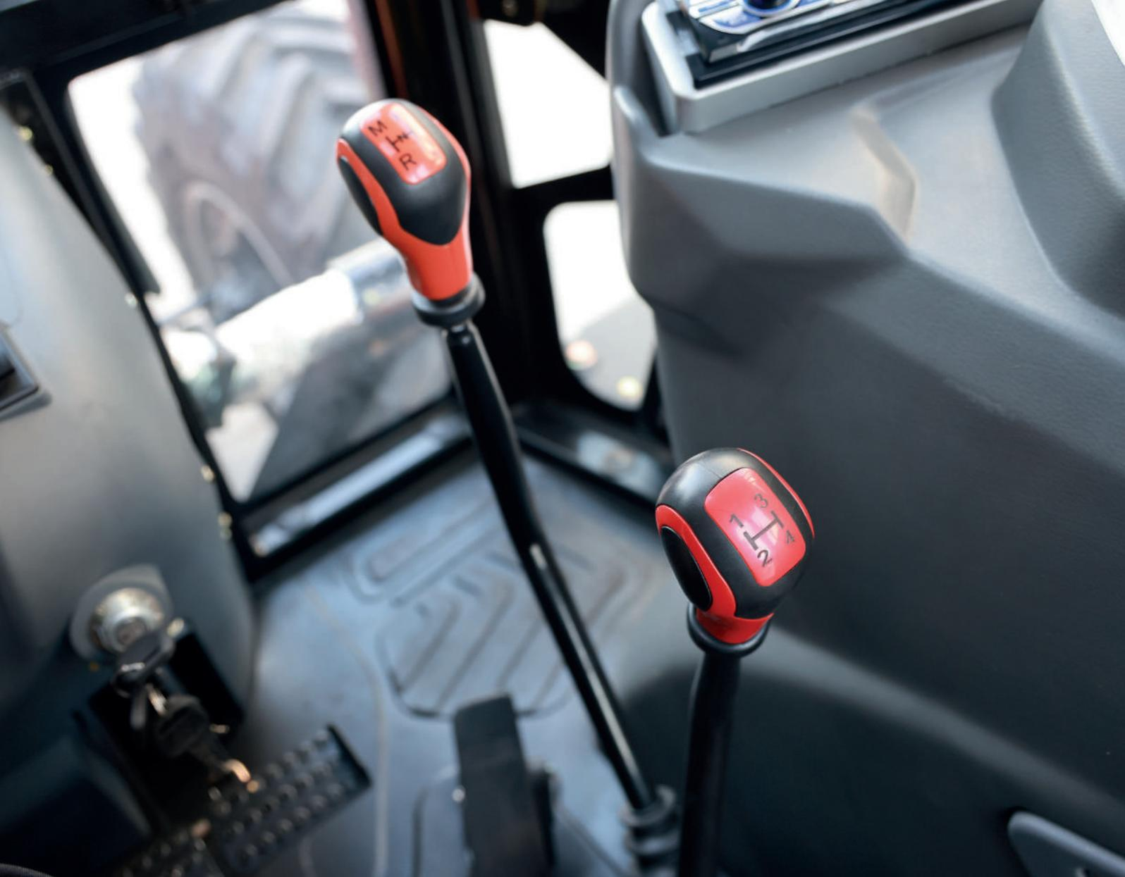
Две силовые передачи (кролик/черепашка) позволяют увеличить производительность в случае работы с тяжелым прицепным орудием на 20 % (к примеру, при вспашке) и повысить топливную эффективность на 13 % благодаря отсутствию потери тягового усилия в момент переключения
