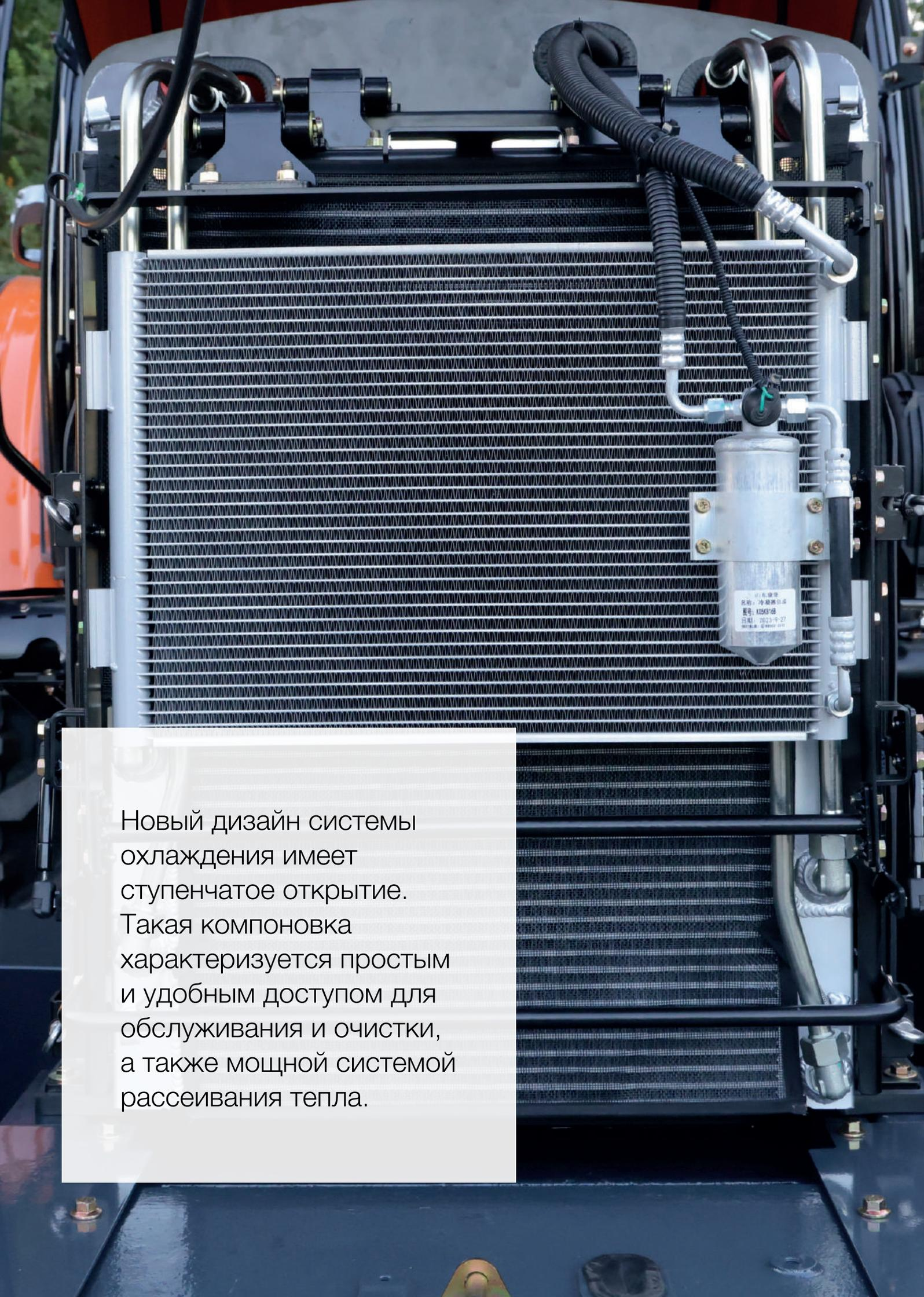
Новый дизайн системы охлаждения имеет ступенчатое открытие. Такая компоновка характеризуется простым и удобным доступом для обслуживания и очистки, а также мощной системой рассеивания тепла.
